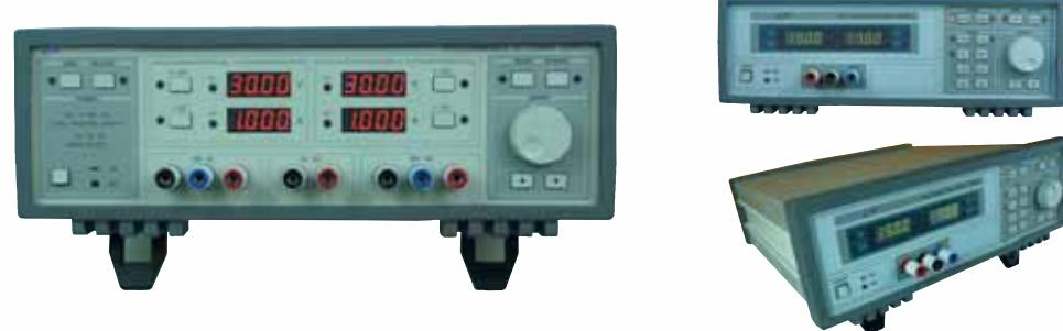
TGP-Series는 기본적으로 RS-232C와 GPIB가 인터페이스를 내장하여 컴퓨터와의 통신 및 제어가 간단하고, 2개의 출력단자는 완전히 독립적으로 되어있습니다. 또한 2개 채널의 전압과 전류를 동시에 변화시킬 수 있는 Tracking도 가능할 뿐만 아니라 로타리 노브에 의해 전압과 전류를 간단히 설정할 수 있는 고정밀 실험실용 전원공급기입니다.
