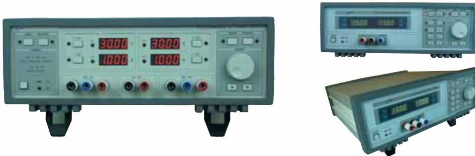
TGP-Series는 기본적으로 RS-232C와 GPIB가 인터페이스를 내장하여 컴퓨터와의 통신 및 제어가 간단하고, 2개의 출력단자는 완전히 독립적으로 되어있습니다. 또한 2개 채널의 전압과 전류를 동시에 변화시킬 수 있는 Tracking도 가능할 뿐만 아니라 로타리 노브에 의해 전압과 전류를 간단히 설정할 수 있는 고정밀 실험실용 전원공급기입니다.
